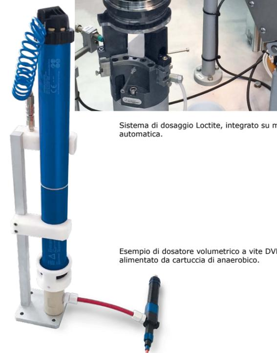
Esempio di dosatore volumetrico a vite DVM alimentato da cartuccia di anaerobico.
